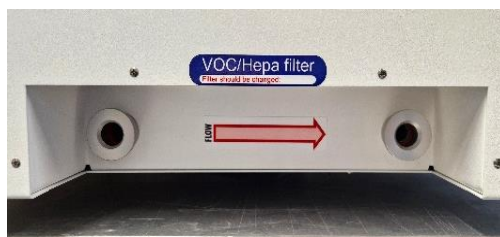
Rysunek 12.1 Strzałka kierunku przepływu na wielokomorowym inkubatorze do IVF MIRI®
