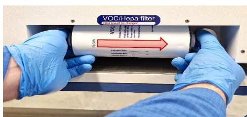
Rysunek 12.2 Procedura montażu i demontażu filtra LZO/HEPA
