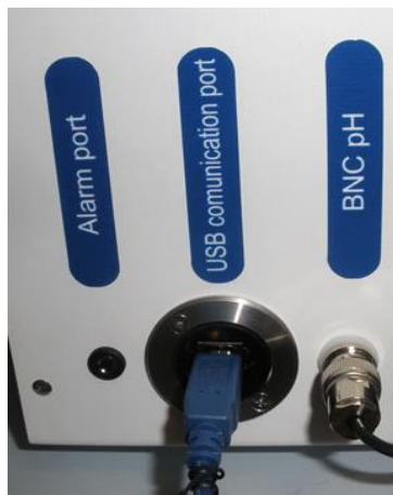
Rysunek 20.1 Sonda odczynu pH podłączona do złącza BNC
