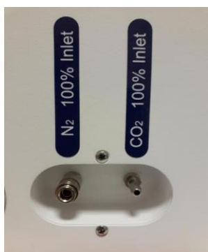
Rysunek 11.1 Dopływy gazu z tyłu wielokomorowych inkubatorów do IVF MIRI® oraz MIRI® Humidity
