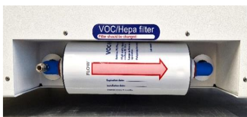
Rysunek 12.3 Prawidłowo zamontowany filtr LZO/HEPA
